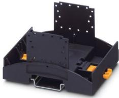
Tragschienengehäuse für den Einsatz in Installationsverteilern nach DIN 43880, Gehäuseunterteil mit Fußriegel, Breite: 71,6 mm, Höhe: 89,7 mm, Tiefe: 48,9 mm, Farbe: schwarz (ähnlich RAL 9005), Querverbindung: Tragschienen-Busverbinder (optional), Polzahl Querverbinder: 16
