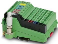
Wireless-IO-Modul, 16 digitale Eingänge, 16 digitale Ausgänge, 2 analoge Eingänge, 2 analoge Ausgänge; Bluetooth V1.2; Frequenzband 2,4 GHz; 1 Funkinterface; WLAN-BlackChannelList; LEM
