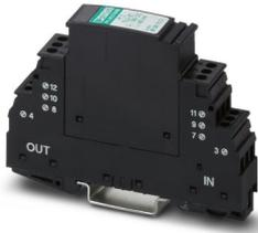
Überspannungsschutzgerät, bestehend aus Stecker und Basiselement, zum Schutz einer Doppelader von analogen und digitalen Telekommunikationsschnittstellen (VDSL bis zu 50 MBit/s, auf kurzen Strecken (< 300 m) bis zu 100 MBit/s).
