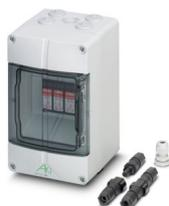
Überspannungsschutz im IP65 Gehäuse für Photovoltaikanlagen, steckbare Varistoren mit thermischer Abtrennvorrichtung zwischen L+, L- und Erde/PE, Anschluss über Multikontakt-Stecker/-Buchse.
