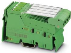
Inline, Analogeingabeklemme, Analoge Eingänge: 4, 0 V ... 5 V, -5 V ... 5 V, 0 V ... 10 V, -10 V ... 10 V, 0 mA ... 20 mA, 4 mA ... 20 mA, -20 mA ... 20 mA, Anschlusstechnik: 2-, 3-, 4-Leiter, Übertragungsgeschwindigkeit im Lokalbus: 2 MBit/s, Schutzart: IP20, inklusive Inline-Steckern und Beschriftungsfeldern
