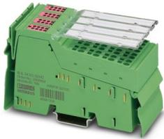
Inline, Digitalausgabeklemme, Digitale Ausgänge: 32 (NPN), 24 V DC, Anschlusstechnik: 1-Leiter, Übertragungsgeschwindigkeit im Lokalbus: 500 kBit/s, Schutzart: IP20, inklusive Inline-Steckern und Beschriftungsfeldern
