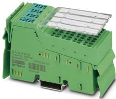
Inline, Digitaleingabeklemme, Digitale Eingänge: 32 (NPN), 24 V DC, Anschlusstechnik: 1-Leiter, Übertragungsgeschwindigkeit im Lokalbus: 500 kBit/s, Schutzart: IP20, inklusive Inline-Steckern und Beschriftungsfeldern
