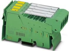
Inline, Analogausgabeklemme, Analoge Ausgänge: 8, 0 V ... 10 V, -10 V ... 10 V, 0 V ... 5 V, -5 V ... 5 V, Anschlusstechnik: 2-Leiter, Übertragungsgeschwindigkeit im Lokalbus: 2 MBit/s, Schutzart: IP20, inklusive Inline-Steckern und Beschriftungsfeldern
