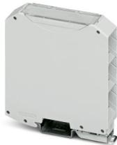
Tragschienengehäuse, Komplettgehäuse mit Metallfußriegel, flache Bauform, ohne Lüftungsschlitze, Breite: 22,6 mm, Höhe: 85 mm, Tiefe: 91,15 mm, Farbe: lichtgrau (ähnlich RAL 7035), Querverbindung: Tragschienen-Busverbinder (optional), Polzahl Querverbinder: 5
