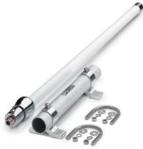
Rundstrahlantenne, 2,4 GHz, Gewinn: 9 dBi, Polarisation: linear, Öffnungswinkel: h/v 360°/15°, Schutzart: IP65, Anschluss: N (female), inkl. Montagewinkel und Mastschellen
