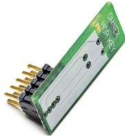
Der HOPKEY beinhaltet Informationen wie z. B. die verwendeten Sendefrequenzen und die Sprungreihenfolge. Diese Informationen benötigt z.B. ein zusätzlicher Empfänger/Repeater, um in ein bestehendes System eingebaut zu werden.
