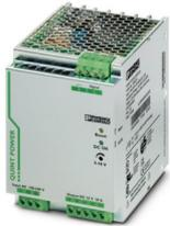
Primär getaktete Stromversorgung QUINT POWER, Schraubanschluss, SFB Technology (Selective Fuse Breaking), Eingang: 1-phasig, Ausgang: 12 V DC / 20 A
