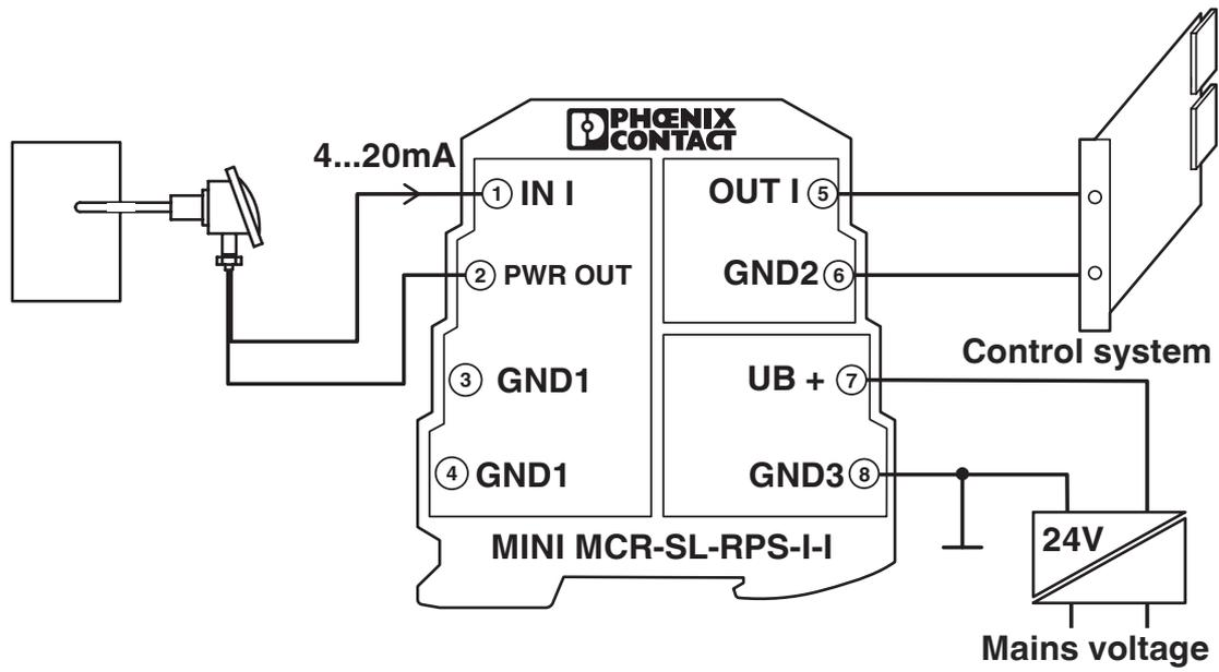
Speisetrennerbetrieb mit passivem Sensor
