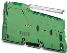
Inline, Analogeingabeklemme, Analoge Eingänge: 2, 0 V ... 10 V, -10 V ... 10 V, 0 mA ... 20 mA, 4 mA ... 20 mA, -20 mA ... 20 mA, Anschlusstechnik: 2-Leiter, Übertragungsgeschwindigkeit im Lokalbus: 500 kBit/s, Schutzart: IP20, inklusive Inline-Stecker und Beschriftungsfeld
