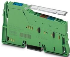
Inline, Digitaleingabeklemme, Digitale Eingänge: 4, 24 V DC, Anschlusstechnik: 3-Leiter, Übertragungsgeschwindigkeit im Lokalbus: 500 kBit/s, Schutzart: IP20, inklusive Inline-Stecker und Beschriftungsfeld
