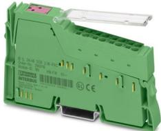
Inline, Relaisklemme, Relaisausgänge: 2 (potenzialfrei), Wechsler, 24 V AC, 48 V DC, zum Schalten von ohmschen Lasten, Übertragungsgeschwindigkeit im Lokalbus: 500 kBit/s, Schutzart: IP20, inklusive Inline-Stecker und Beschriftungsfeld
