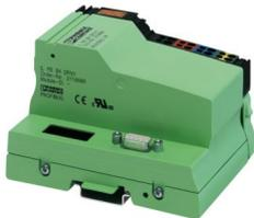
Inline, Buskoppler, PROFIBUS DP, D-SUB-9-Buchse, Übertragungsgeschwindigkeit im Lokalbus: 500 kBit/s, Schutzart: IP20, inklusive Inline-Stecker und Beschriftungsfeld
