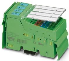
Inline, Digitaleingabeklemme, Digitale Eingänge: 8, 24 V DC, Anschlusstechnik: 4-Leiter, Übertragungsgeschwindigkeit im Lokalbus: 500 kBit/s, Schutzart: IP20, inklusive Inline-Steckern und Beschriftungsfeldern
