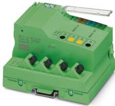
Inline, Buskoppler, INTERBUS, F-SMA-Stecker, 45° abgeschrägter Lichtwellenleiter-Anschluss, Übertragungsgeschwindigkeit im Lokalbus: 500 kBit/s, Schutzart: IP20, inklusive Inline-Stecker und Beschriftungsfeld
