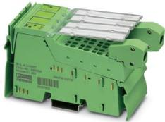
Inline, Analogeingabeklemme, Analoge Eingänge: 2, 4 mA ... 20 mA, 0 mA ... 25 mA, Anschluss technik: 2-Leiter, Übertragungsgeschwindigkeit im Lokalbus: 500 kBit/s, HART-Funktionalität, HART-Protokollübertragung, Schutzart: IP20, inklusive Inline-Steckern und Beschriftungsfeldern
