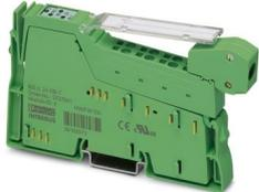
Inline, Abzweigklemme, INTERBUS, Inline-Schirmstecker, mit Fernbusstich, Übertragungsgeschwindigkeit im Lokalbus: 2 MBit/s, Schutzart: IP20, inklusive Inline-Stecker und Beschriftungsfeld
