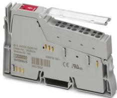
Inline, Relaisklemme, Relaisausgang: 1 (potenzialfrei), Wechsler, 24 V AC, 230 V AC, zum Schalten von ohmschen Lasten, Übertragungsgeschwindigkeit im Lokalbus: 500 kBit/s, Schutzart: IP20, inklusive Inline-Stecker und Beschriftungsfeld
