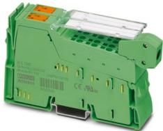
Inline-Zählerklemme, komplett mit Zubehör (Anschlussstecker und Beschriftungsfelder), 1 Zählereingang, 1 Steuereingang, 1 Ausgang, 24 V DC, 500 mA, 3-Leiter-Anschluss technik
