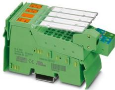
Inline-Positionierklemme, komplett mit Zubehör (Anschlussstecker und Beschriftungsfeld), 1 Inkrementalwertgeber-Eingang, 4 digitale Eingänge 24 V DC, 4 digitale Ausgänge 24 V DC, 500 mA, 3-Leiter-Anschlussstechnik
