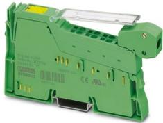
Inline, Analogausgabeklemme, Analoger Ausgang: 1, 0 V ... 10 V, Anschlusstechnik: 2-Leiter, Übertragungsgeschwindigkeit im Lokalbus: 500 kBit/s, Schutzart: IP20, inklusive Inline-Stecker und Beschriftungsfeld
