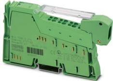
Inline, Temperaturerfassungsklemme, Analoge UTH-Eingänge: 2 (Thermoelemente oder lineare Spannung), Anschluss technik: 2-Leiter, Übertragungsgeschwindigkeit im Lokabus: 500 kBit/s, Schutzart: IP20, inklusive Inline-Stecker und Beschriftungsfeld
