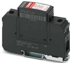
Überspannungsableiter bestehend aus Basiselement und Schutzstecker mit Hochleistungsvaristor, zur Montage auf NS 35/7,5, Nennspannung: 230 V AC, 1-kanalig.
