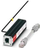
Überspannungsfeinschutz gem. Class D (CAT.5e), für Token Ring und Ethernet. RJ45-Zwischenstecker mit separater Erdungsleitung, inkl. RJ45-Kabel
