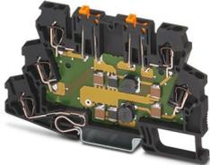
TERMITRAB, Federkraft-Reihenklemme mit integriertem Überspannungsschutz als Filterschaltung und Trennmessern, zur Montage auf NS 35/7,5, Spannung  $U_N$  24 V DC, Klemmenbreite: 6,2 mm, Deckelbreite: 2,2 mm
