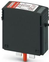
Überspannungsschutzstecker Typ 2 mit Hochleistungsvaristor für VAL-MS-Basiselement, thermisch überwacht, optische Defektmeldung. Ausführung: 320 V AC
