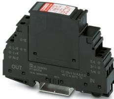
Steckbarer Typ 3 - Ableiter (Geräteschutz) für 1-phasige Stromversorgungsnetze mit separatem N und PE (3-Leitersystem: L1, N, PE), mit Fernmeldekontakt.
