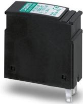
Schutzstecker mit leckstromfreier Schutzschaltung für zwei erdpotenzialfrei betriebene Signale. Reihenschaltung aus Varistor und gasgefülltem Überspannungsableiter zwischen den Signaladern und Erde.
