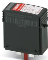
Überspannungsschutzstecker Typ 2 mit Reihenschaltung aus Varistor und gasgefüllter Funkenstrecke für VAL-MS-Basiselement, thermisch überwacht, optische Defektmeldung.
