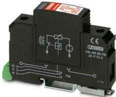
Überspannungsableiter bestehend aus, Basiselement mit FM-Kontakt und Schutzstecker mit Reihenschaltung aus Varistor und gasgefüllter Funkenstrecke, zur Montage auf NS 35/7,5, Nennspannung: 230 V AC, 1-kanalig
