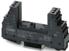
Basiselement für Schutzstecker PT mit Schutzschaltung für einen 2-adrige erdpotenzialfrei betriebenen Signalkreis. Integrierter Gasableiter als Grobschutz zwischen GND und PE. Montage auf NS 35/7,5 und NS 35/15, Gehäusebreite: 17,5 mm.
