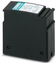
Überspannungsschutzstecker für Basiselement, Grob- und Feinschutz für zwei Signaladern mit gemeinsamem Bezugspotenzial, Längsspannungsgrobschutz zur Erde. Ausführung: 12 V DC
