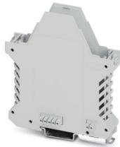
Tragschienengehäuse, Gehäuseunterteil mit Metallfußriegel, mit FE-Kontakt, hohe Bauform, mit Lüftungsschlitzen, Breite: 22,6 mm, Höhe: 99 mm, Tiefe: 107,3 mm, Farbe: grün (ähnlich RAL 6021), Querverbindung: integrierter Busverbinder, Polzahl Querverbinder: 5+2, Busverbinder: 5 parallele Kontakte, 2 serielle Kontakte
