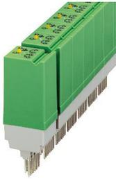
Relaisstecker, bestückt mit Kleinschaltrelais, Kontakte (AgNi): mittlere bis große Leistungen, 2 Schließer, Eingangsspannung 24 V AC/DC, mit Leuchtanzeige, steckbar auf Grundklemmenblöcke
