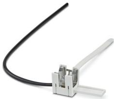
Schirmschnellanschluss für Leitungsdurchmesser 5 ... 10 mm. Potenzialanschlussleitung: 200 mm, 1 mm<sup>2</sup>, Farbe: schwarz
