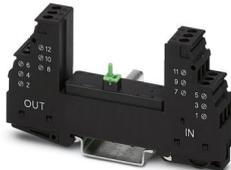
Basiselement für Schutzstecker PT mit Schutzschaltung für zwei 2-adrige erdpotenzialfrei betriebene Signalkreise, Gasableiter zwischen den Anschlüssen 3-4 (GND) und 9-10, Montage auf NS 35/7,5 und NS 35/15, Gehäusebreite: 17,5 mm
