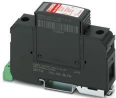
Überspannungsableiter bestehend aus Basiselement mit FM-Kontakt und Schutzstecker mit Hochleistungsvaristor, zur Montage auf NS 35/7,5, Nennspannung: 230 V AC, 1-kanalig
