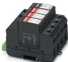
Überspannungsableiter bestehend aus Basiselement mit FM-Kontakt und Schutzsteckern, zur Montage auf NS 35/7,5, Nennspannung: 230 V AC, 3 + 1-Schaltung
