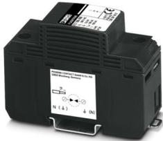
Typ 1 / Class I / B-Ableiter (Blitzstromableiter) mit gekapselter N-PE-Summenstromfunkenstrecke, 1-kanalig. Gehäusebreite: 35 mm (2TE)
