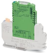
Ex i Binär Eingang: NAMUR-Trennschaltverstärker. Zum Betrieb von Näherungsinitiatoren und Schaltern im Ex-Bereich. Die Binärsignale werden in den sicheren Bereich übertragen. Relaisausgang (Schließer), Leitungsfehlererkennung. Galvanische 3-Wege Trennung.
