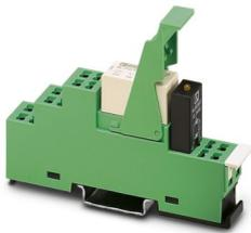
Vormontierte Relaismodule mit Zugfederanschluss, bestehend aus: Relaissockel, steckbarem Miniaturleistungsrelais mit Leistungskontakten, steckbarem Anzeige-/ Entstörm modul und Relaishaltebügel. Eingangsspannung: 230 V AC, Kontakte: 2 Wechsler, 8 A
