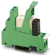
Vormontierte Relaismodule PR1-RSC... mit Schraubanschluss, bestehend aus: Relaissockel, Mehrlagenkontaktrelais, steckbarem Anzeige-/ Entstörm modul und Haltebügel. Eingangsspannung: 120 V AC, 1 Wechsler, 12 A
