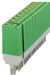
Relaisstecker, bestückt mit Kleinschaltrelais, Kontakte (AgNi): mittlere bis große Leistungen, 1 Schließer, Eingangsspannung 230 V AC, mit Leuchtanzeige, steckbar auf Grundklemmenblöcke
