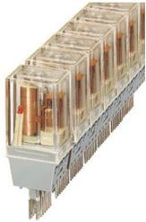
Relaisstecker, bestückt mit Hengstler-Klein-Rund-Relais, Kontakte (AgCdO+Au): kleine bis große Leistungen, 2 Wechsler, Eingangsspannung 24 V AC, mit Leuchtanzeige, steckbar auf Grundklemmenblöcke
