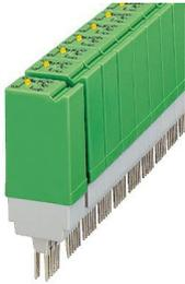
Relaisstecker, bestückt mit Kleinschaltrelais, Kontakte (AgNi): mittlere bis große Leistungen, 1 Wechsler, Eingangsspannung 230 V AC, mit Leuchtanzeige, steckbar auf Grundklemmenblöcke
