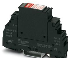
Tragschienenmontabler Überspannungsableiter als Geräteschutz für Endgeräte, Defektsignal im Stecker und Meldekontakt im Basiselement, zweiteilig steckbar. Ausführung: 48 V DC
